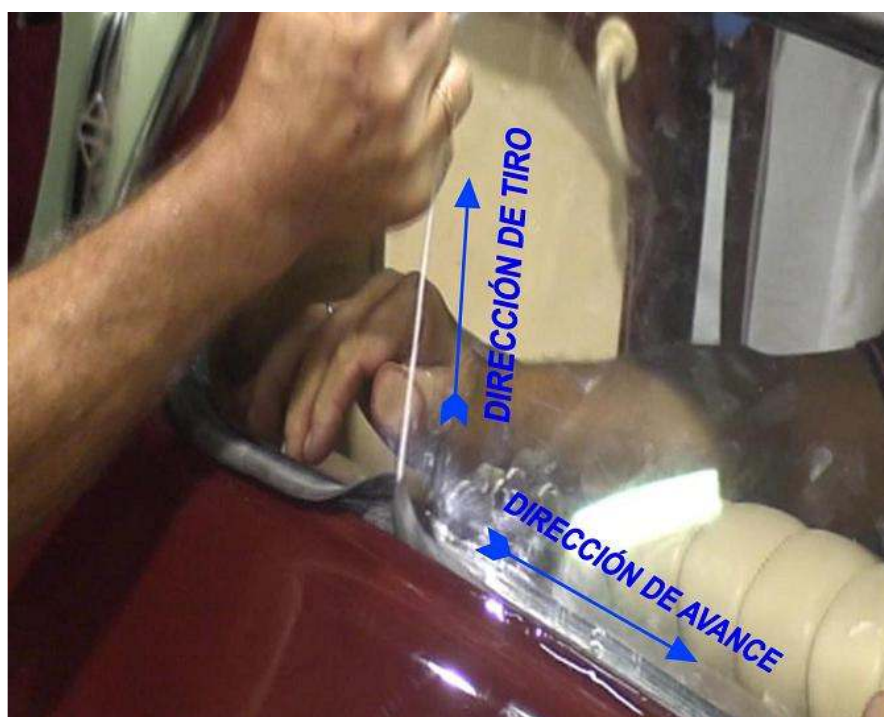
Figura 4 - Dirección de estirado del cordón
