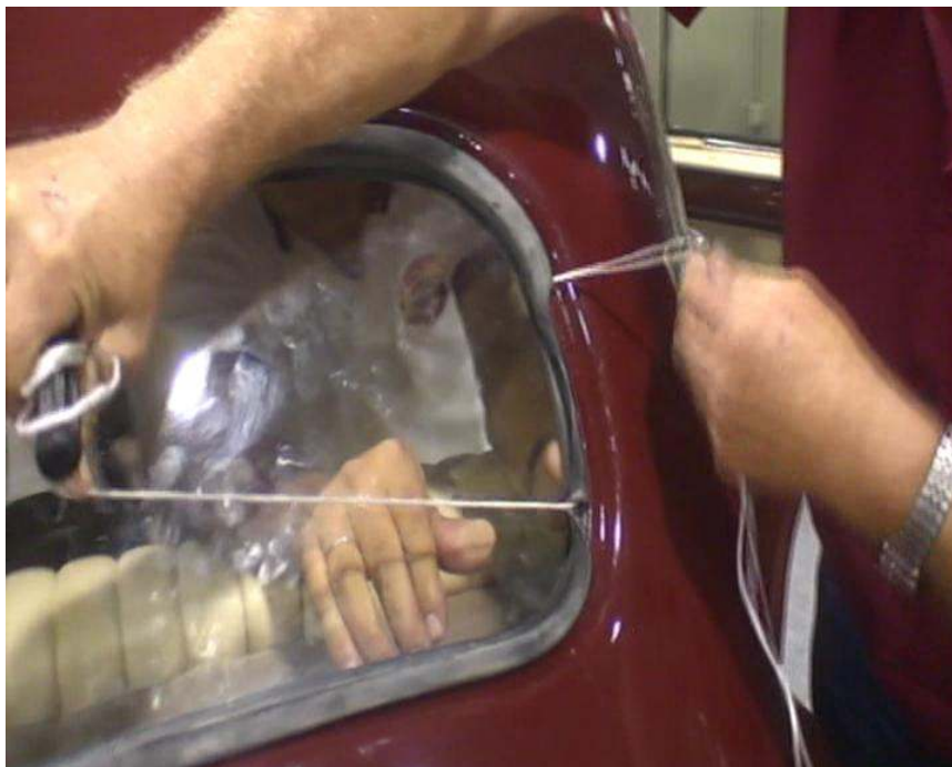
Figura 5 - Extracción del último tramo de cordón
